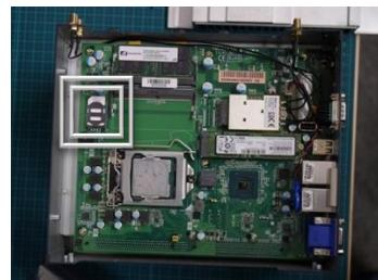
なお、取り外したヒートシンク部に着いている黄色の物体はヒートシンクパッドでデバイスの熱をヒートシンク部逃がすもので取らないでください。また、CPU の部分にはヒートシンク用グリースが塗ってありますので、これも取らないでください。また、少なければ市販のもので結構ですので足してください。
